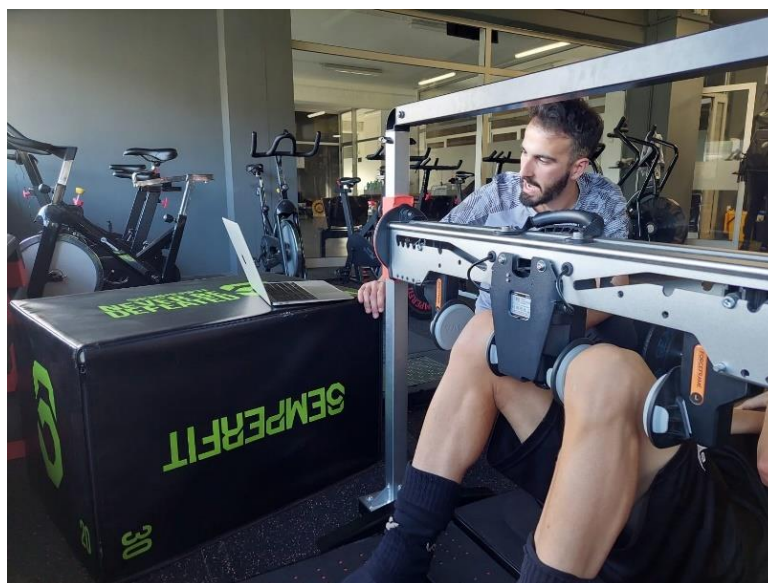
Figura 10 Execução de um teste de força de adutores na ForceFrame
